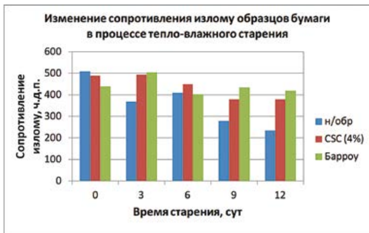
Рис. 12. Изменение показателя сопротивления излому образцов бумаги, необработанных и обработанных буфером Барроу и карбонизированным пропилатом магния, в процессе тепло-влажностного старения
