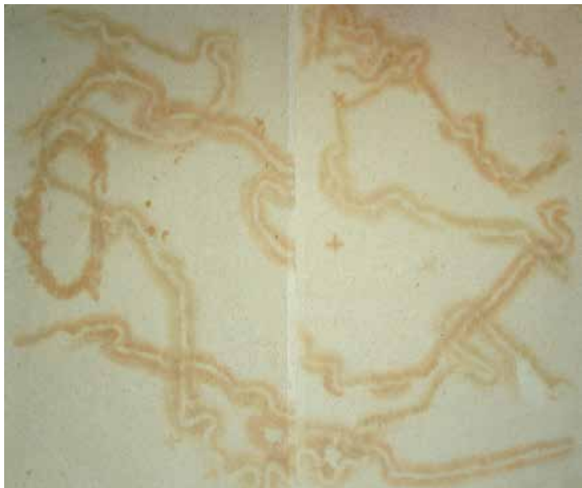
Рис.5. Повреждение бумаги под действием зеленой краски: оборотная сторона — контурно выделяются следы зеленой краски, нанесенной на лицевую сторону и на последующий лист
