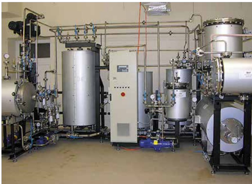
Рис. 9. Общий вид оборудования для массовой нейтрализации кислотности бумаги по технологии CSC Book Saver
