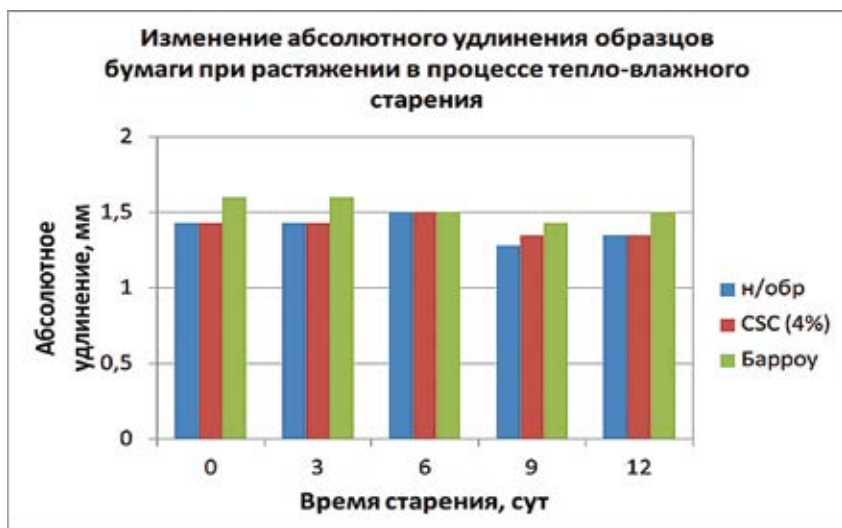
Рис. 14. Изменение абсолютного удлинения образцов бумаги, необработанных и обработанных буфером Барроу и карбонизированным пропилатом магния, в процессе тепло-влажного старения
